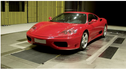
5 벨트 Rolling Road 시스템
