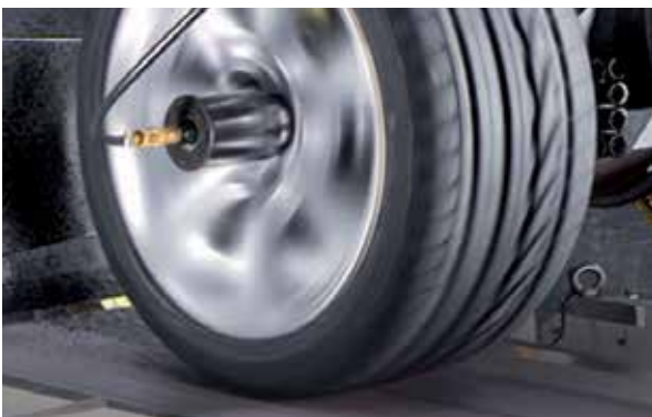
©IABG mbH IABG 平面トラックタイヤテストスタンド Flat-Trac® III CT ミュンヘン/オットブルン
